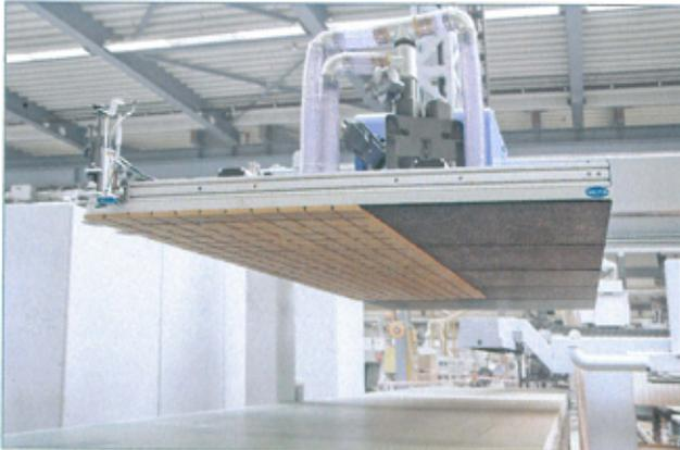
Schmalz Nesting-Greifer zur Handhabung verschnittoptimierter Holzplatten
